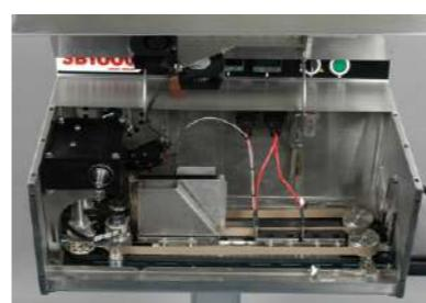
Sur les **soudeuses SB à bandes la chaleur des barres de chauffe est transmise au sac à travers les bandes téflonnées**.
