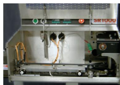
Les **soudeuses SR radiantes** utilisent le principe de **transfert de chaleur émis par les mors chauffants**.
