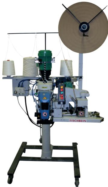
Un système de couture ferme automatiquement les sacs à gueule ouverte par couture (cette couture peut se faire avec un cavalier de papier crêpé ou avec un repli du haut du sac). Un système de couture Fischbein est composé d'une colonne, d'un support de tête, d'une tête de couture, d'un entraîneur pour guider le sac vers la couture et d'un coffret électrique.
