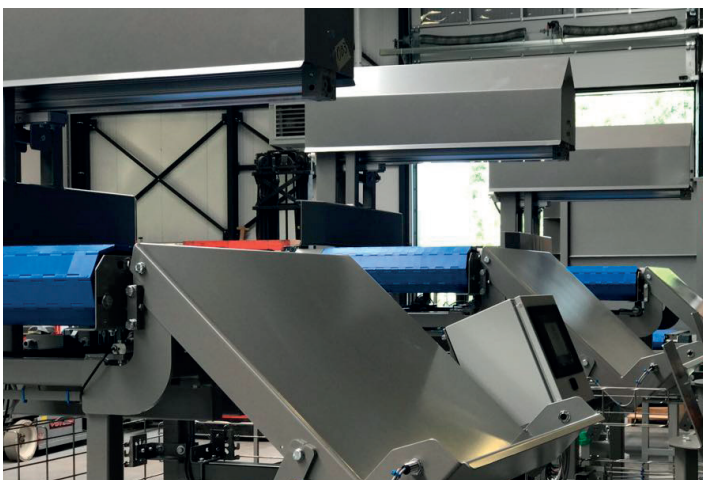
Checkweger met geïntegreerde reject unit
